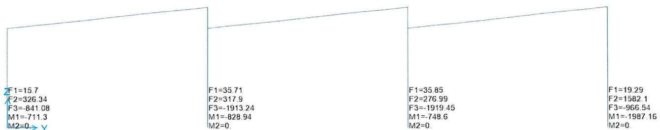
風載重柱底反力(風向 180°, 內風壓為負)
