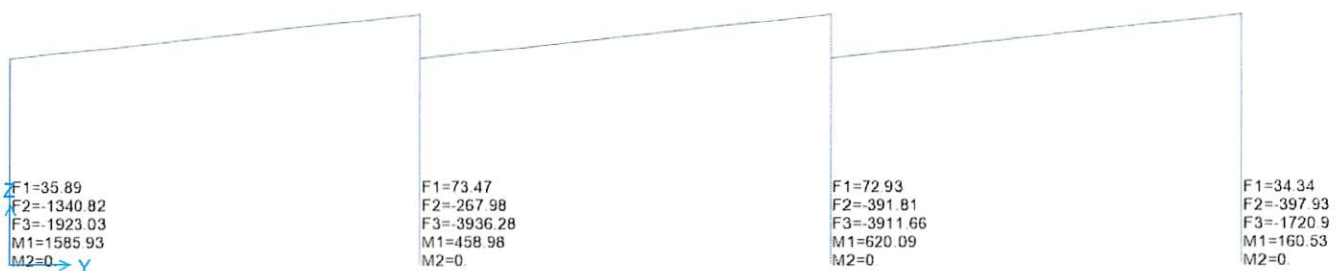
風載重柱底反力(風向 0°，內風壓為正)
